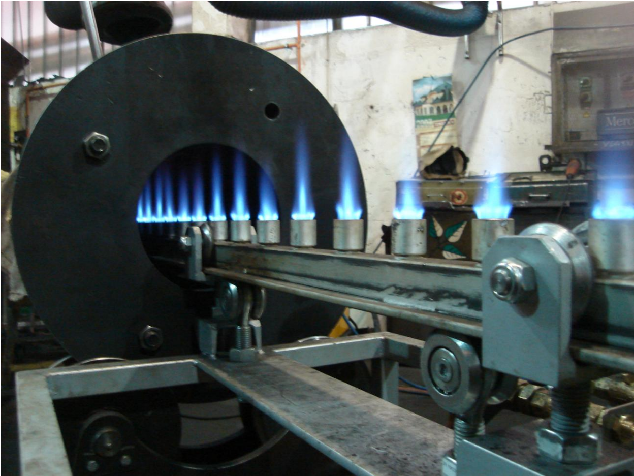
Slika 4; drobilni valj pred varjenjem
